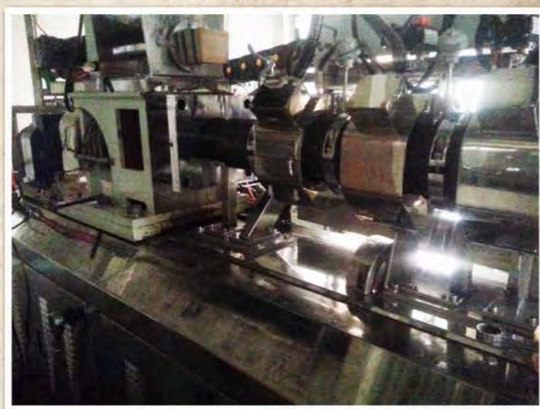
擠壓成型機 extruding briquetting machine
